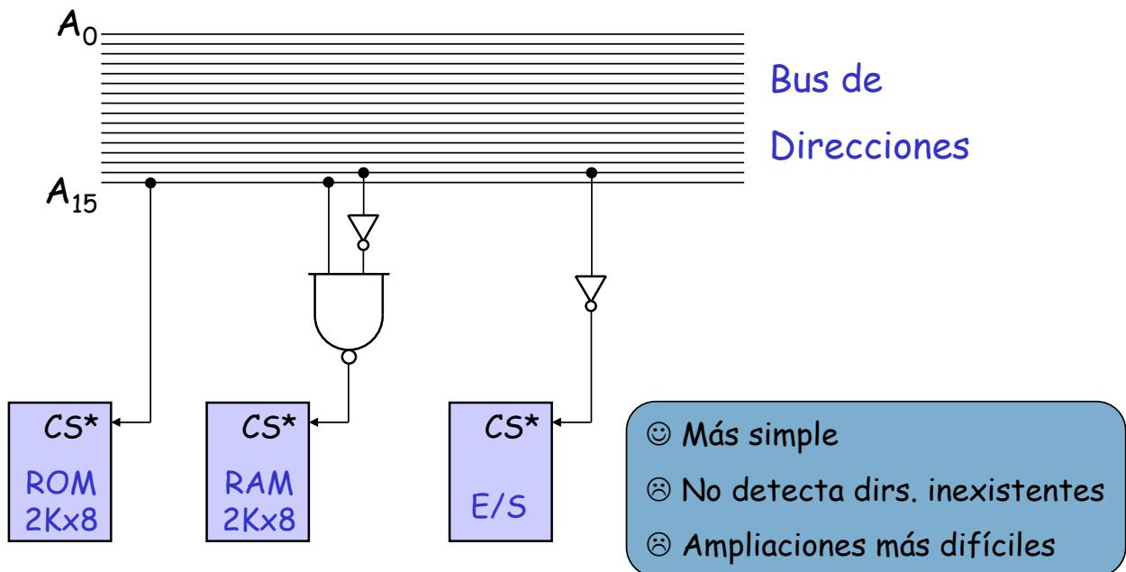
En el caso del ejemplo anterior, hemos necesitado las 5 señales de dirección de mayor peso para identificar la ROM y la RAM, y las 14 de mayor peso para identificar las direcciones de los puertos de E/S.
