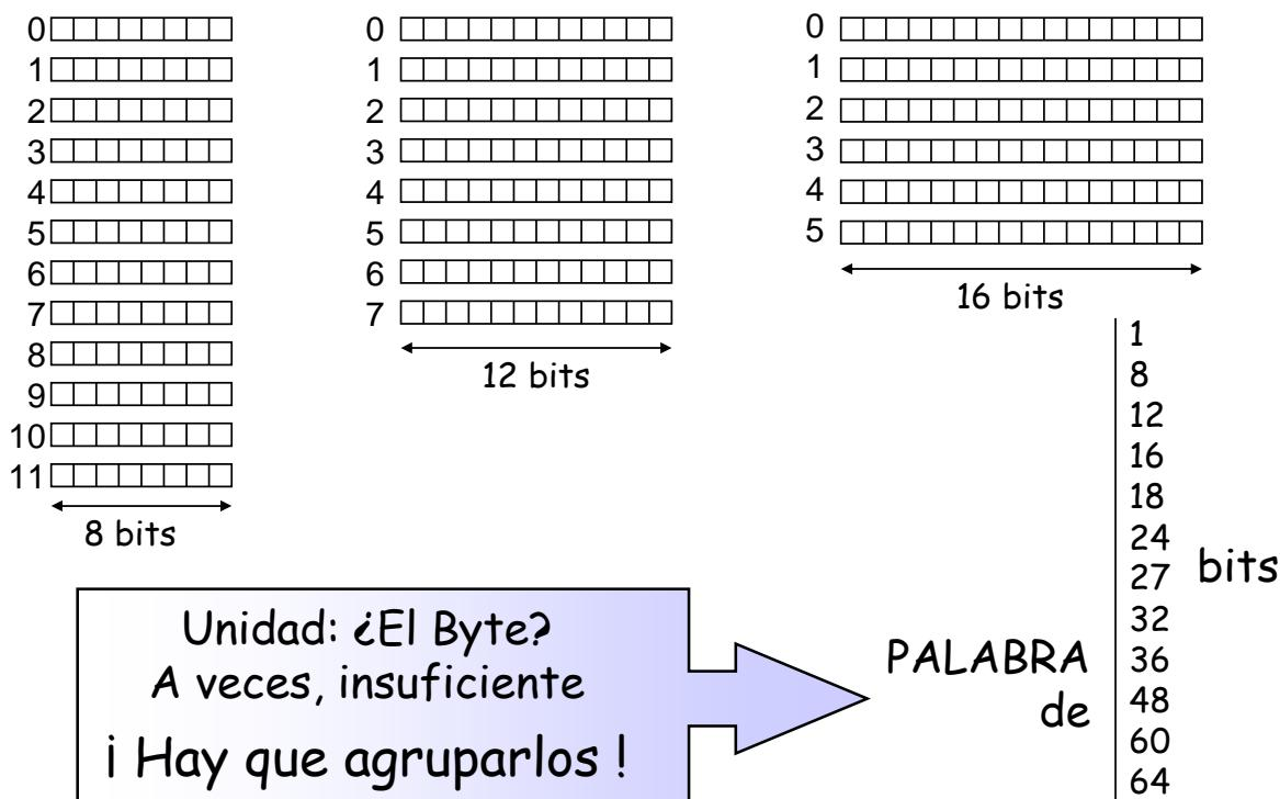
En la figura vemos que una memoria de 96 bits puede organizarse de varias maneras. Algunas de ellas son: 6 celdas de 16 bits, 8 celdas de 12 bits o 12 celdas de 8 bits.
