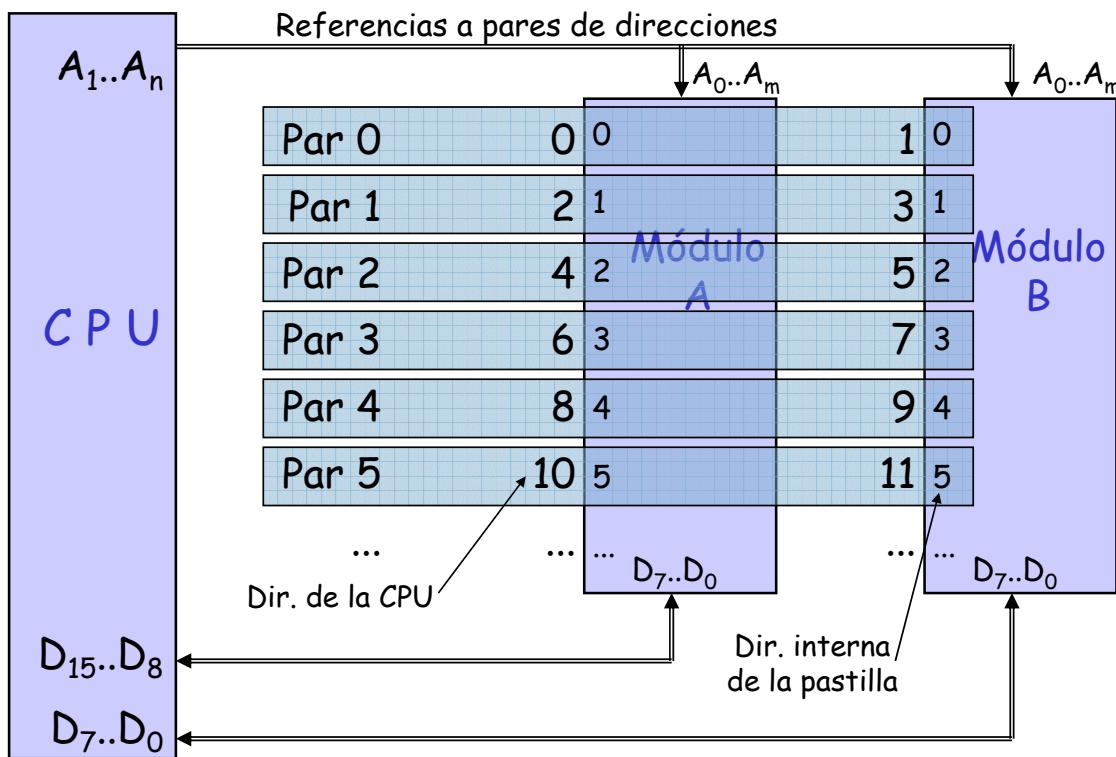
Según lo visto en la página anterior, en realidad, para arquitecturas con un bus de datos de 16 bits, desde la CPU se hace referencia a "pares de direcciones", donde el par 0 se refiere a las direcciones 0 y 1; el par 1, a la 2 y la 3; el par 2, a la 4 y la 5, etc. etc.
