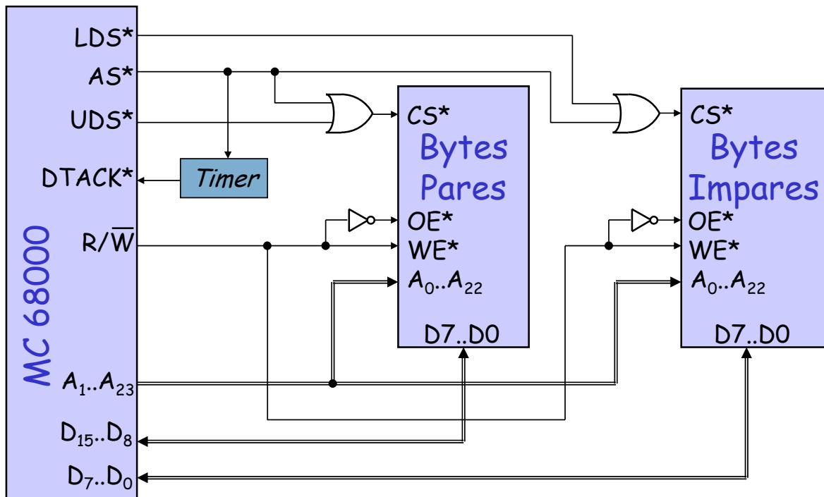
Ahora presentaremos, mediante un ejemplo simple, la interconexión entre el procesador 68000 de Motorola y 16 Mbytes de memoria formada mediante dos módulos o chips de 8 Mbytes cada uno.
