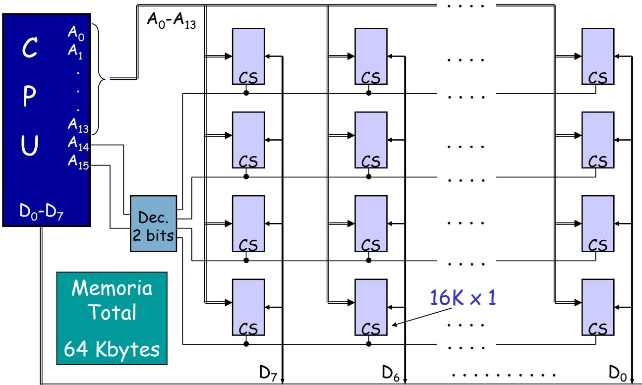
En este ejemplo tenemos un sistema con una memoria de 64 Kbytes formada a base de módulos de 16 K x 1, esto quiere decir que cada chip dispone de 14 patas de direcciones y una de datos.
