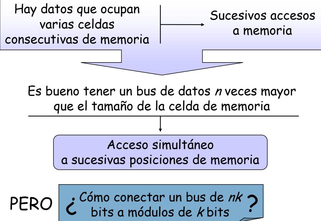
Ya hemos visto que un módulo básico de memoria está formado por una o varias pastillas de memoria, tal que, en conjunto, ofrece una serie de celdas de direcciones consecutivas de  $k$  bits cada una y que, por lo tanto, el módulo básico tiene  $k$  hilos de datos para su conexión al bus de datos del procesador.
